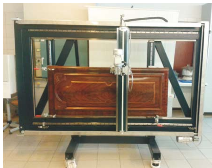
STANOWISKO POMIAROWE, MIERZONE SKRZYDŁO DRZWIOWE O WYMIARACH 1600 x 670 MM.
